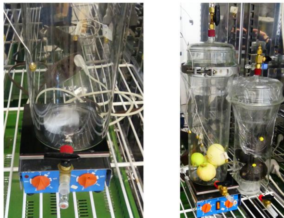
Abbildung 46: Gasmesszelle für verschiedene Proben. Beispiel einer Lagerung von Äpfeln und Avocados in der Gasmesszelle (rechts) mit nebenstehendem Beispiel einer Gasmesszelle mit artifiziellem Gasgemisch und sich drehendem Magnetrührer mit Segel (links). Entnommen aus: (Köhne et al., 2021).
