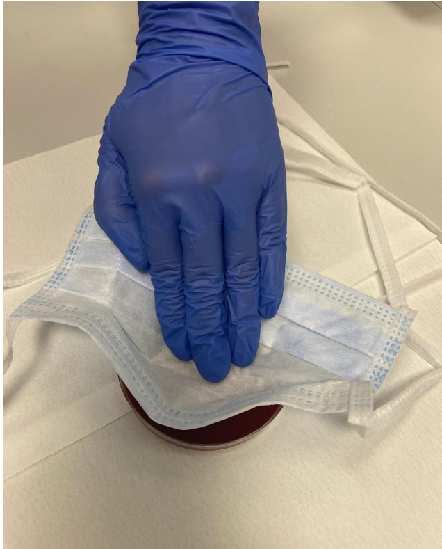
Abbildung 6: Kontaktprobe der zentralen Außenfläche des Mund-Nasen-Schutzes auf einer Agarplatte Quelle: Janina Lang
